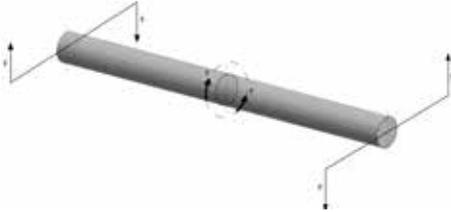
Une tension de frottement apparaît si deux couples de serrage opposés sont appliqués sur un fil ou une tige. Un couple est en fait le même qu'un « moment » (force x bras de force), seul le mot « couple » est utilisé lorsqu'il s'agit d'un mouvement de rotation.
