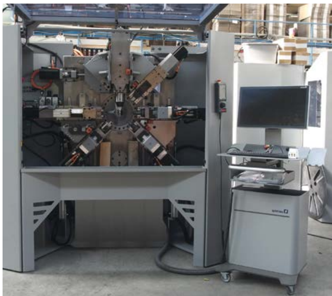
Найновітніший центр виробництва з цифровим керуванням (CNC), оснащений в найновші технології WAFIOS
